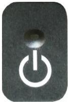
El botón externo de encendido y muestreo de un toque en el mango encenderá y apagará el instrumento y activará y desactivará el muestreo.
