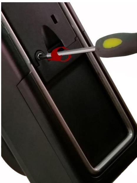
Paso 1 - Retire el tornillo de seguridad con un destornillador Phillips
