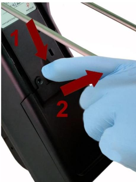
Paso 3: empuje hacia abajo el pestillo mientras tira de la tapa del compartimento de la batería hacia afuera
