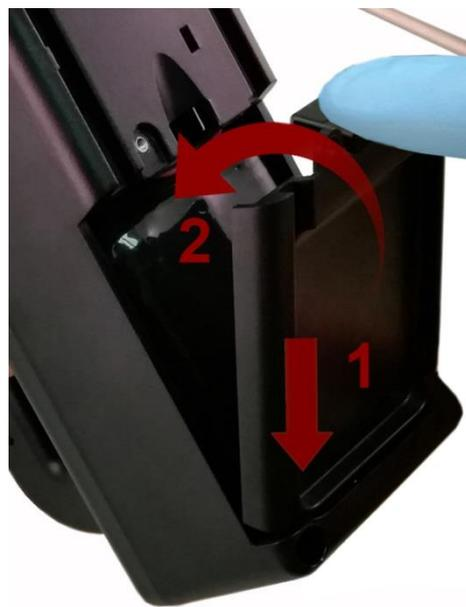
Paso 6: coloque la tapa del compartimento de la batería en la ranura inferior y empuje hacia adentro hasta que el pestillo de bloqueo haga clic. El tornillo de seguridad se puede reinstalar con un destornillador o se puede quitar para el uso opcional de reemplazo de la batería
