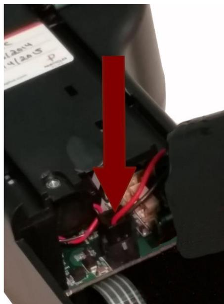
Paso 4: inserte el enchufe del conector de la batería en el zócalo correspondiente en la placa PCB en el compartimento de la batería
